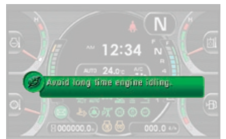
Eco-Hinweise ermöglichen Energieeinsparungen in Echtzeit (z.B. lange Motorleerlaufphasen verhindern)
