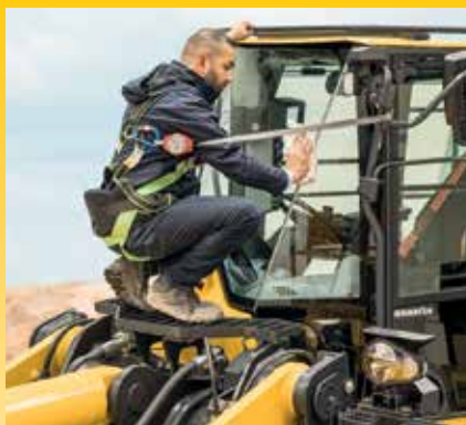
Die Trittfläche vor der Kabine ermöglicht eine sichere und leichte Reinigung der Windschutzscheibe
