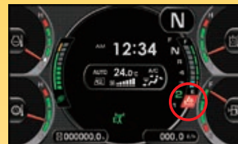
AdBlue®-Füllstandanzeige und Nachfüllhinweis
