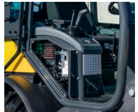
Seitliche Wartungsklappe für schnellen Wartungszugang
