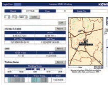
Arbeitszeiterfassung - Die Arbeitszeitübersicht liefert präzise Angaben über die Motorlaufzeiten der Maschine. Es lässt sich genau ablesen, wann der Motor angelassen oder abgestellt wurde.
