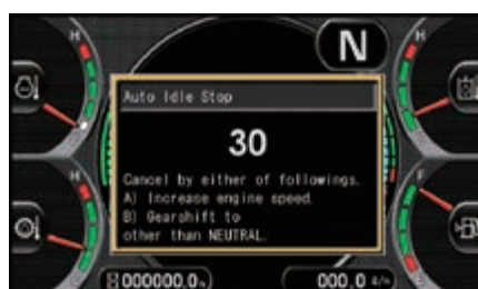
L'arrêt automatique réglable en cas de ralenti prolongé éteint automatiquement le moteur après une période d'inactivité prédéfinie.
