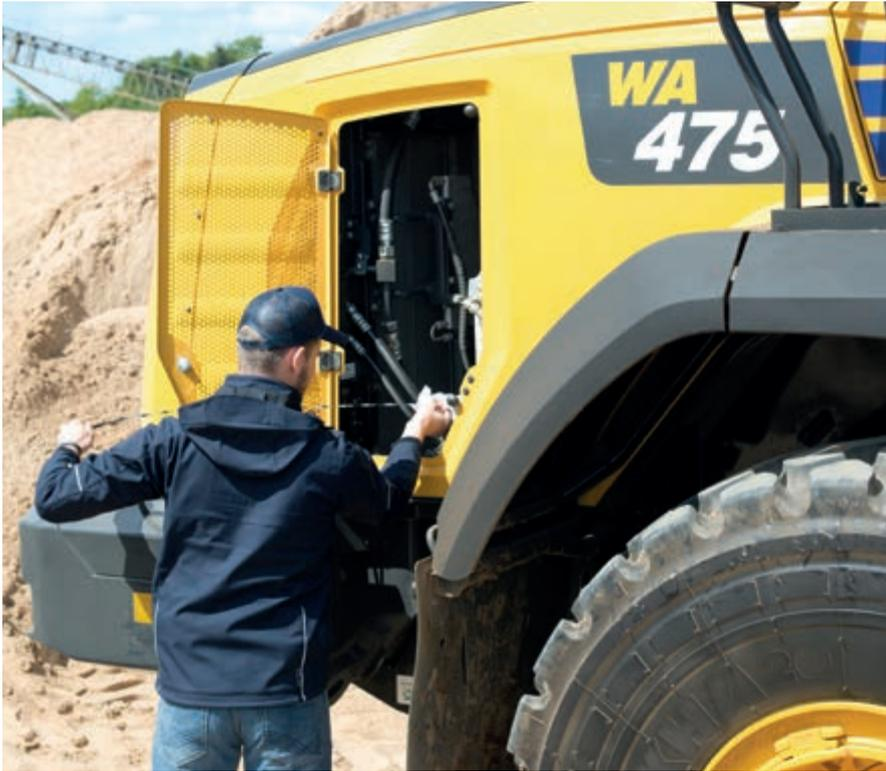
Des portes de service bien positionnées permettent un accès aisé et sûr aux points d'entretien quotidien
