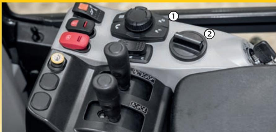
Commandes de conception nouvelle. Le sélecteur de commande (1) permet une navigation aisée dans les menus de l'écran, comme dans une voiture particulière. Le nouveau régulateur de vitesse de déplacement (2) maintient la vitesse de la machine constante en descente.
