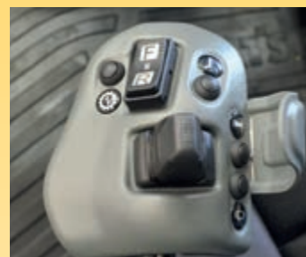
Levier court de direction Komatsu (K-SLS) (option)
