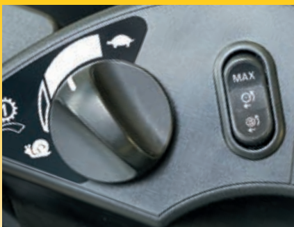
Commande de changement de vitesses variable avec plage de vitesse d'approche lente (gauche) et commutateur de limiteur de couple (TCS) variable (droite)
