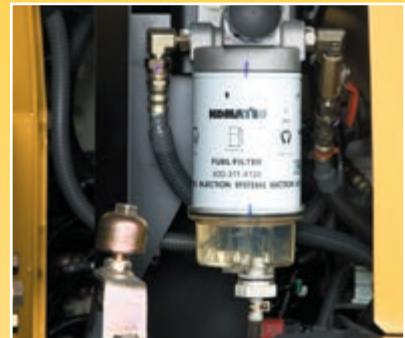
Der Kraftstoffvorfilter mit Wasserabscheider
