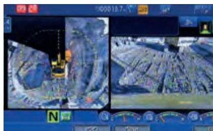
KomVision nutzt verschiedene Kameraansichten um eine permanente „Birdview“-Draufsicht auf die Maschine zur Verfügung zu stellen
