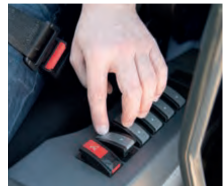
Ergonomische, beleuchtete Schalter für sicheren und einfachen Einsatz bei Dunkelheit
