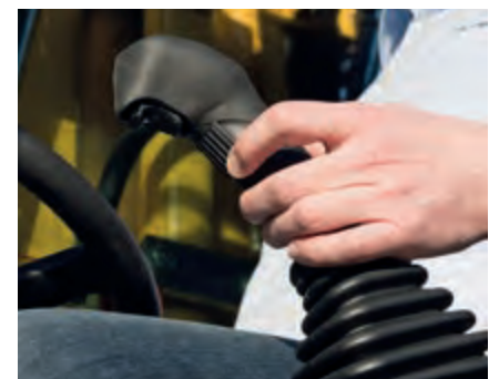
Das optional verfügbare und anpassbare Joystick-Lenksystem ermöglicht leichtgängiges Lenken der Maschine ohne großen Kraftaufwand
