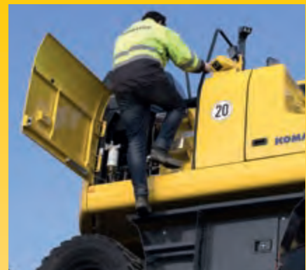
Handläufe und rutschfeste Oberflächen
