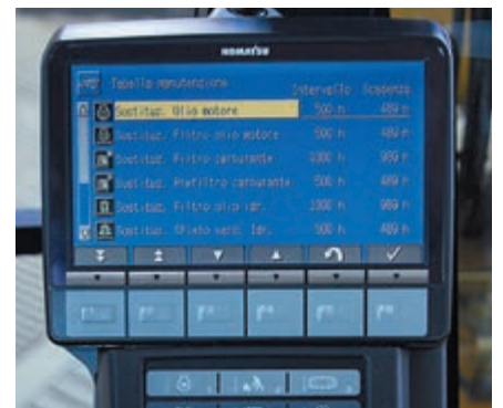
Der LCD-Monitor zeigt Unregelmäßigkeiten und Wartungsintervalle an
