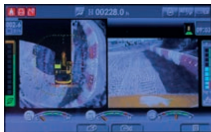
KomVision offre plusieurs vues grâce au réseau de caméras, tout en maintenant affichée en permanence une vue aérienne, depuis le dessus de la machine
