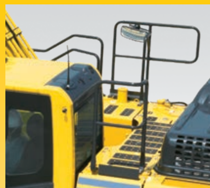
Main courantes et plaques antidérapantes
