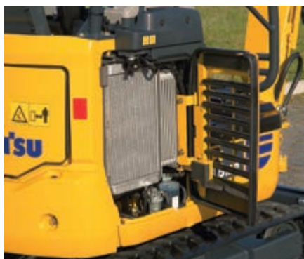
Capot latéral droit: simple inspection et nettoyage des radiateurs
