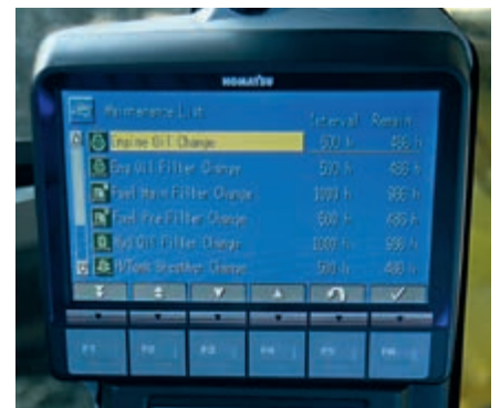
Der LCD-Monitor zeigt Unregelmäßigkeiten und Wartungsintervalle an
