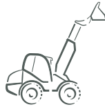
Teleskopradlader Schaufelinhalt: 0,65 - 1,45 m 3
