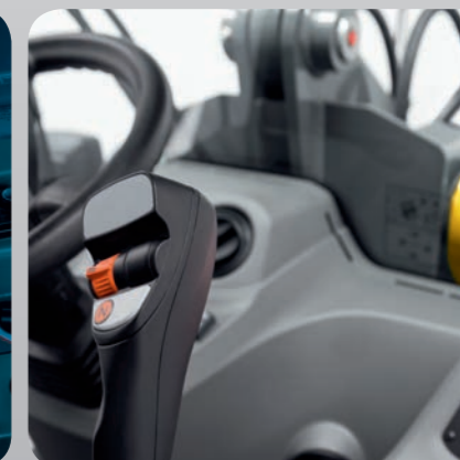
Pilotage réactif et précis de la machine et de l'équipement au moyen d'un joystick à commande pilote mécanique.
