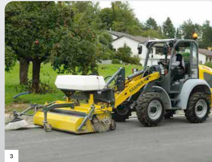
2 Mulcheinsatz mit powerflow Leistungshydraulik 3 Kehrschneideneinsatz mit effizientem 3. Steuerkreis (serienmäßig)
