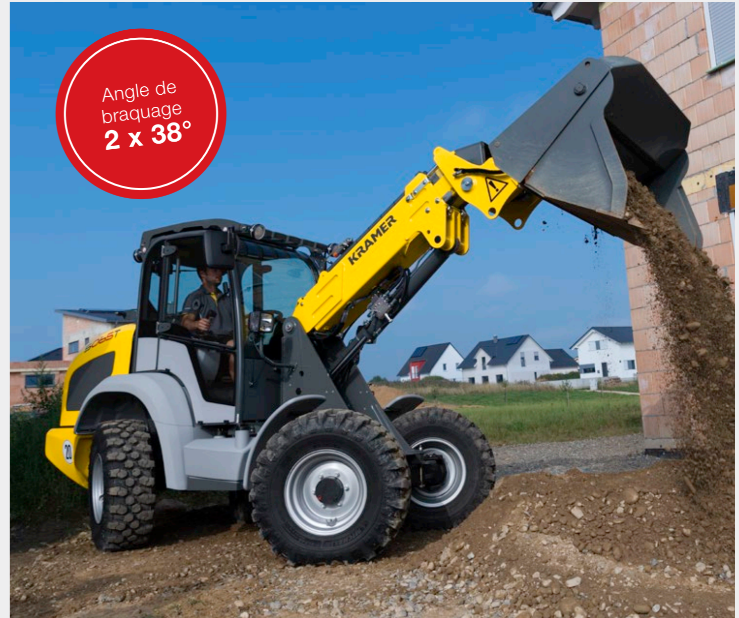
Quatre roues directrices : pour une grande maniabilité dans les espaces restreints.
